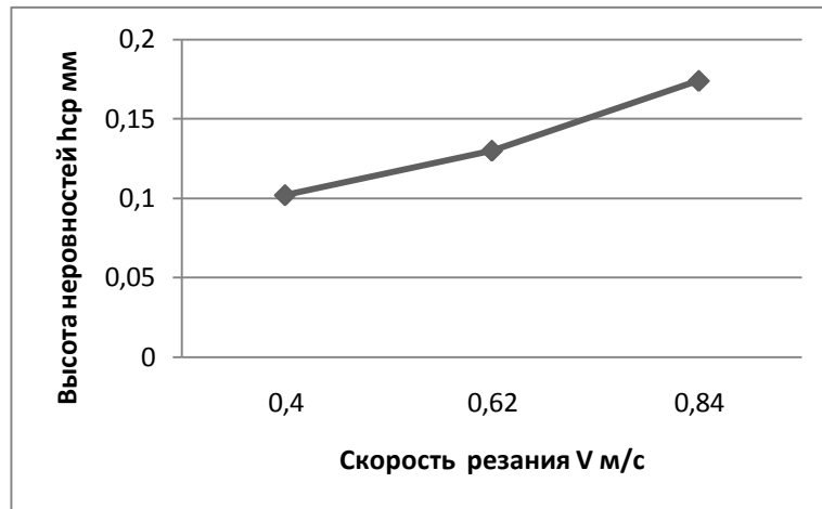
Рисунок 2 – График изменения h_{ср} в зависимости от скорости резания для паза 1
