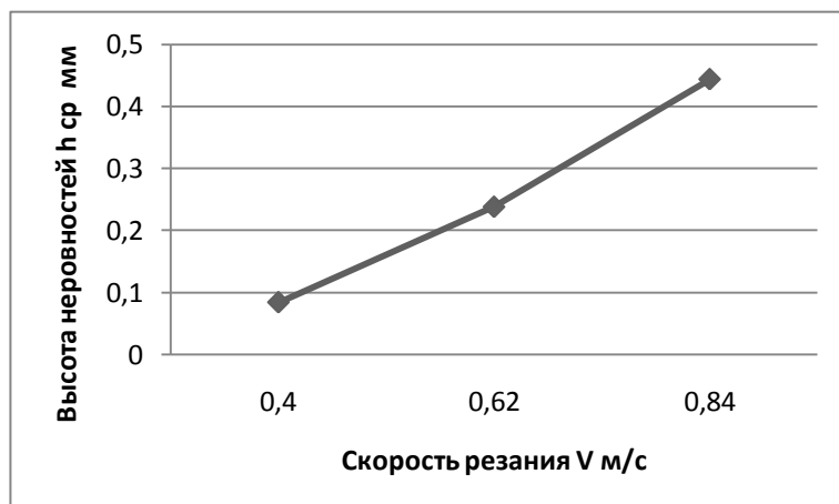
Рисунок 5 – График изменения h_{ср} в зависимости от скорости резания для паза 4
