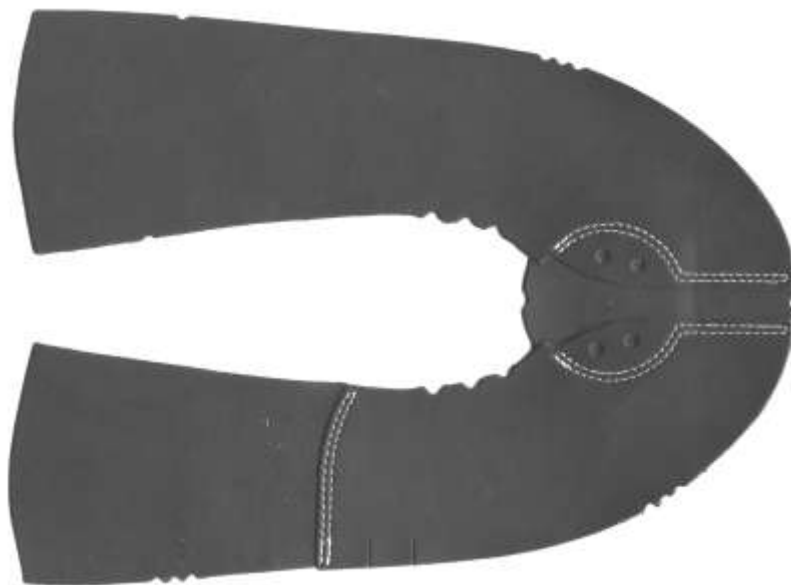
Рисунок 3 – Заготовка, собранная на полуавтомате ПШ-1
