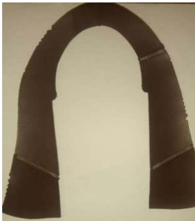
Рисунок 3 – Заготовка, собранная на полуавтомате ПШ-1
