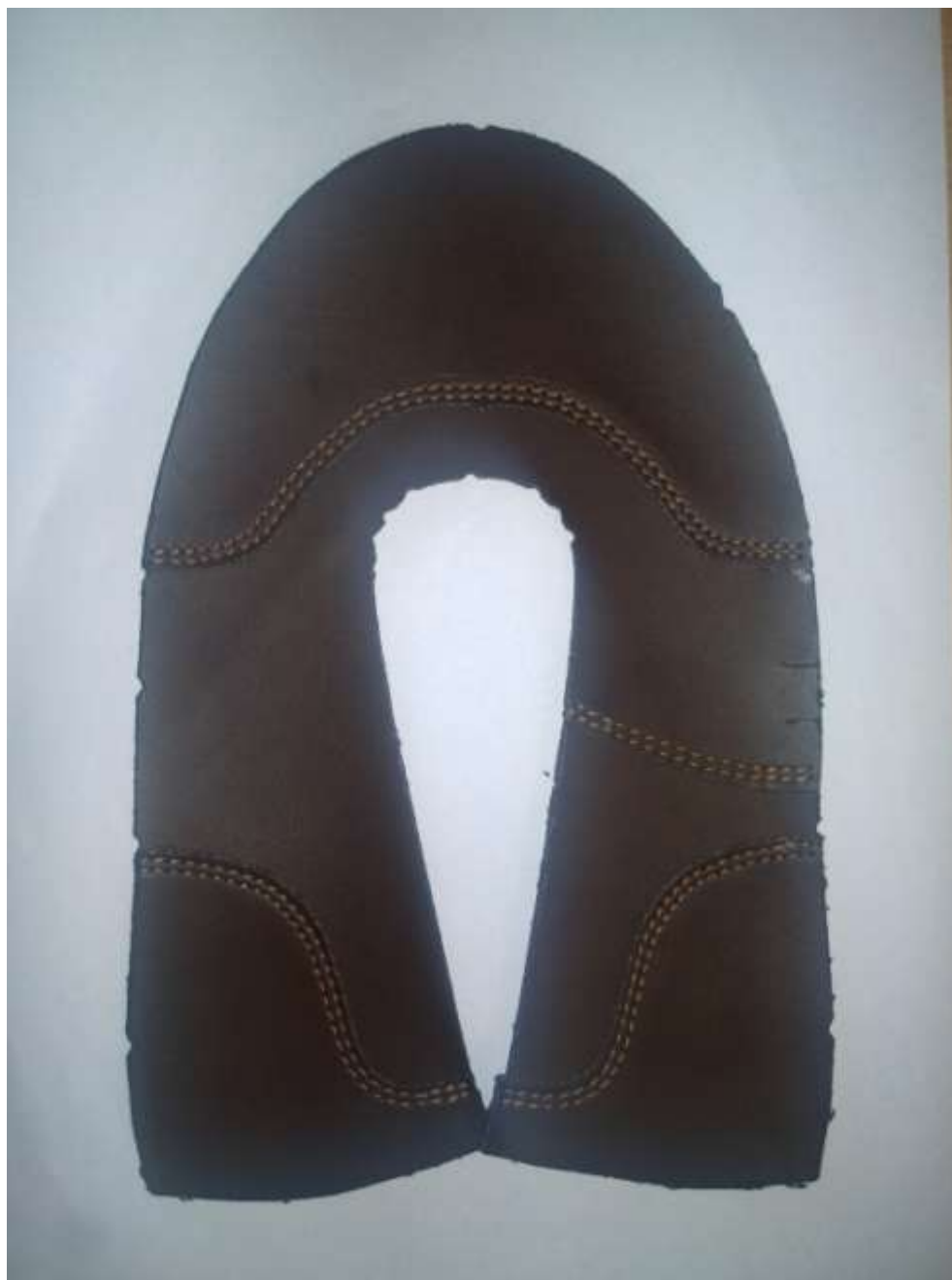
Рисунок 3 – Заготовка, собранная на полуавтомате ПШ-1
