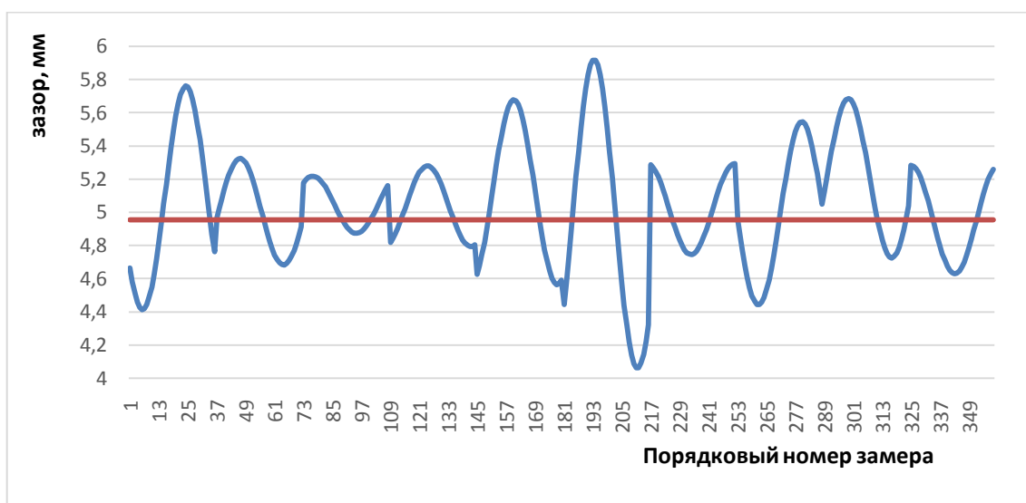
Рисунок 5 – Зазор для детали диаметром 29,73 мм
