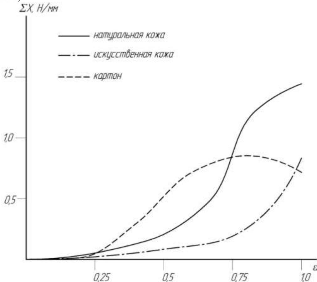
Рисунок 2 – Графики сил  $\sum X$ , приходящиеся на 1 мм длины лезвия резака
