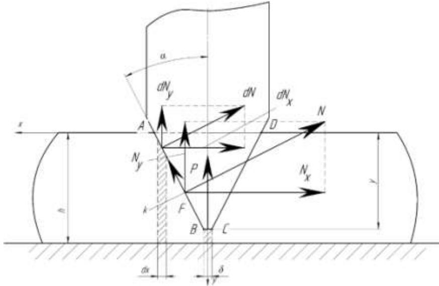
Рисунок 1 – Схема сил, действующих на участки AB и BC резака
