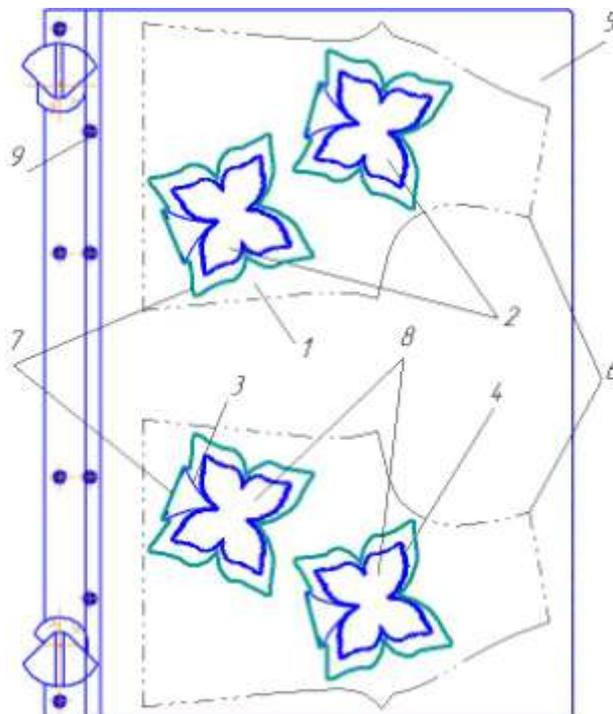
Рисунок 2 – Кассета с деталями верха обуви и аппликации
